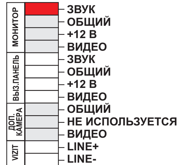
Цоколёвка соединительного разъёма
